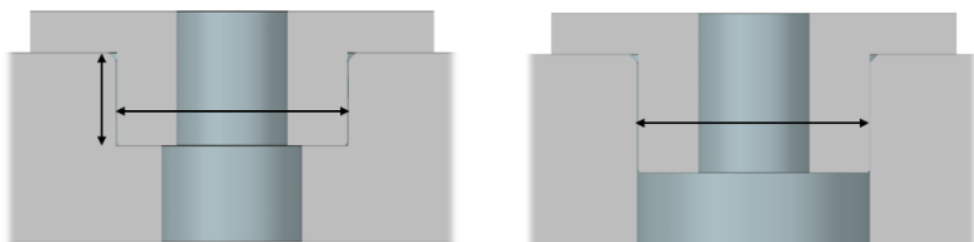
Kuva 10. Vasemmalla kahden mitan on oltava täsmällisiä, jotta osa istuu hyvin. Oikealla tähän riittää yksi mitta. (Muokattu lähteestä Pahl et al. 2013, s. 381)
