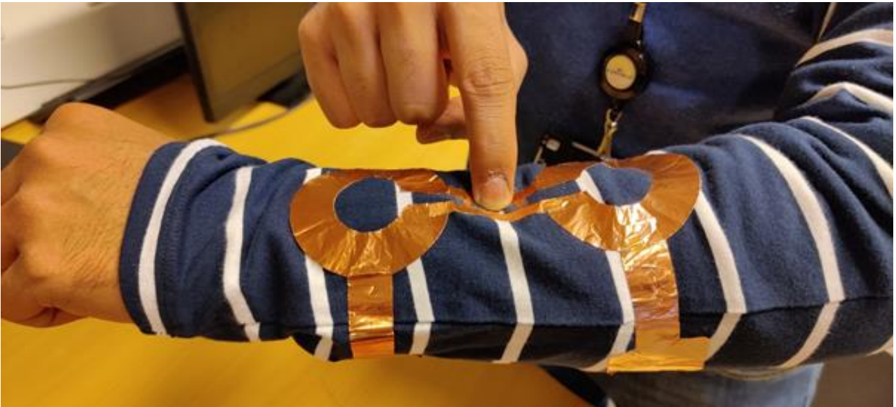
Kuva 1. Puettava käyttöliittymä eli älyvaate toimii muun muassa kosketuksella tai kehon liikkeellä (kuva: Mehmood Adnan, 2020).
