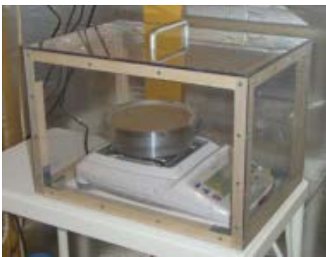
Kuva 1. Märkäkuppikokeen toimintaperiaate ja koekuppi punnituksessa. [2]
