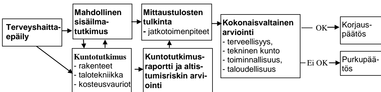
Kuva 1. Sisäilmaselvitysprosessi rakennuksessa, jossa epäillään terveyshaittaa.
