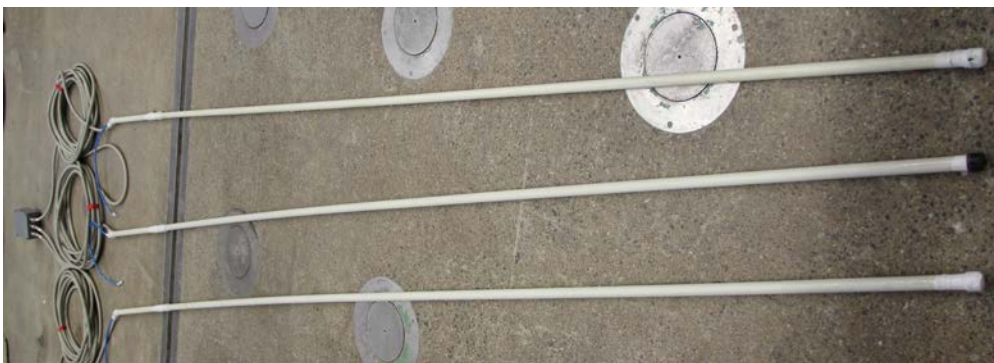
Kuva 2. Lämpötilojen mittausputkia ennen asennusta kohteeseen.
