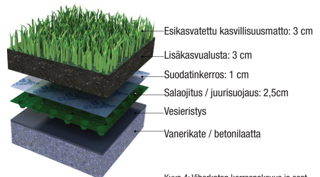
Kuva 4: Viherkaton kerrospaksuus ja osat.
