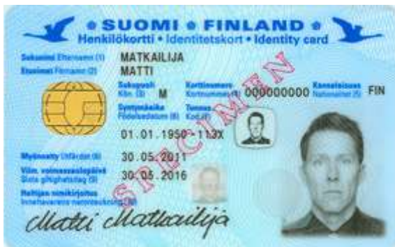
Kuva 9. Poliisin myöntämän henkilökortin siru sisältää haltijansa yksityisen avaimen sekä Väestörekisterikeskuksen myöntämän kansalaisvarmenteen. Kuva: Poliisi.
