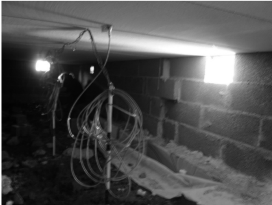
Kuva 5.17 Yleiskuva kohteen C ryömintätilan olosuhteista ja instrumentoidusta mittauslinjasta.
