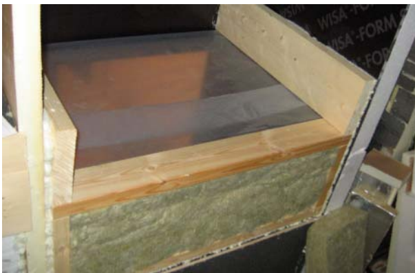
Kuva 2. Ilmansulun teippaamaton limitys katsottuna kylmäkammion puolelta (vasen) ja lämpimän kammion puolelta (oikea).
