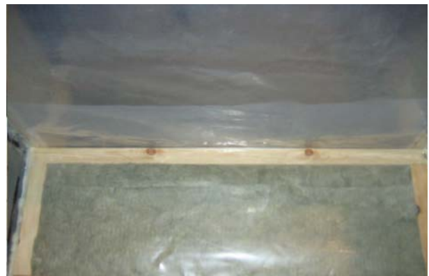
Kuva 2. Ilmansulun teippaamaton limitys katsottuna kylmäkammion puolelta (vasen) ja lämpimän kammion puolelta (oikea).
