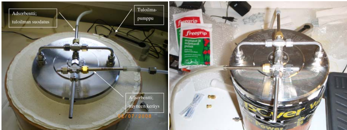
Kuvat 1 ja 2. Koejärjestelyt FLEC-näytteenotosta.
