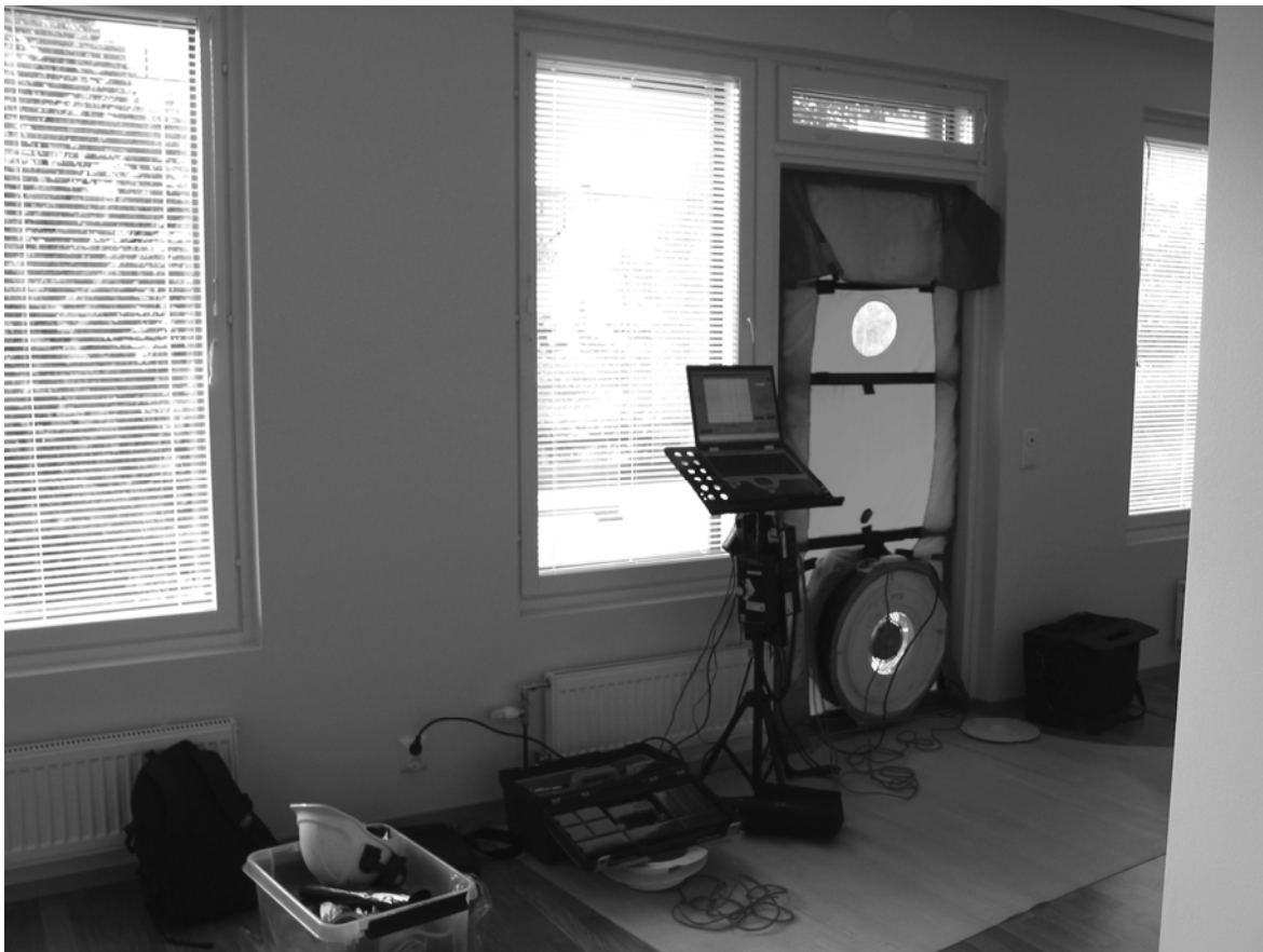
Kuva 1. Blower Door -laitteisto parvekeoveen asennettuna.
