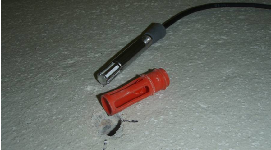
Kuva 2. Esimerkki nykyaikaisen kosteusmittausanturin ja vanhojen mittausholkkien käyttämisestä samassa kohteessa.
