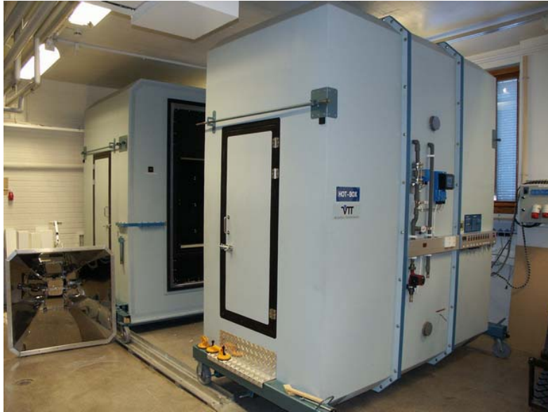
Kuva 2. VTT:n guarded calibrated hot box, jolla mitataan ovien, ikkunoiden ja seinäelementtien lämmönläpäisykerroin eurooppalaisiin standardeihin perustuen.
