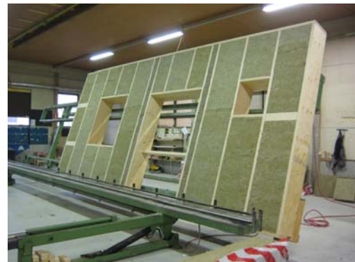
Kuva 4. Passiivitalo Lupauksen ulkoseinärakenne. Seinän kokonaiseristyspaksuus on 478 mm ja U-arvo 0,086 \text{ W/m}^2\text{K} . (Kuvat Arkkitehtuuritoimisto Kimmo Lylykangas).
