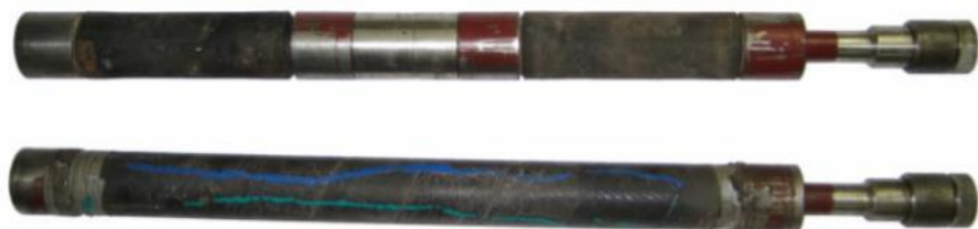
Kuva 12. Mindat Australia Ltd:n valmistaman MiniFrac-järjestelmän osa murtamiseen (yläpuolella) ja osa rakoilu painaman ottamiseen (alempi), joka käyttää mekaanista karttapiirturia (Majapuro 2003).
