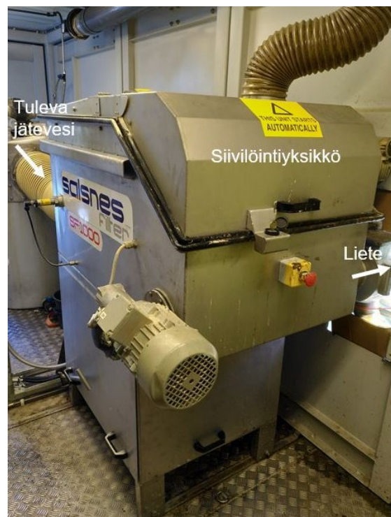
Kuva 7. Kokeissa käytetty mikrosiivilälaitteisto 1.
