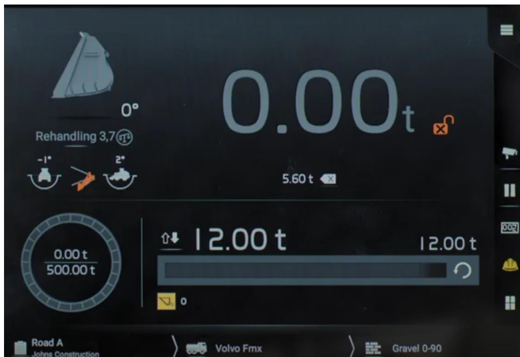
Kuva 5: Load Assist-järjestelmän käyttöliittymä [23]
