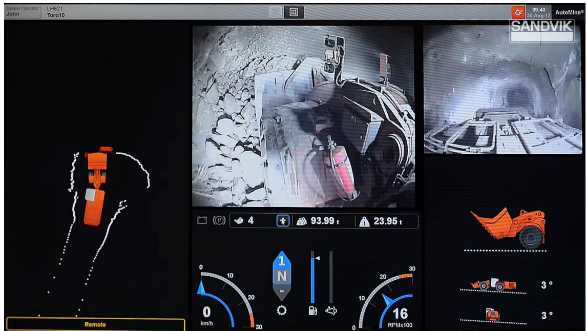
Kuva 7: Operaattorin näytön näkymä etävalvomossa [19]
