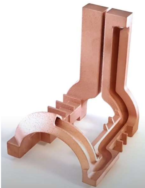
Kuva 5 GKN:n 3D-tulostama induktiokäämi induktiokarkaisuun (GNK).
