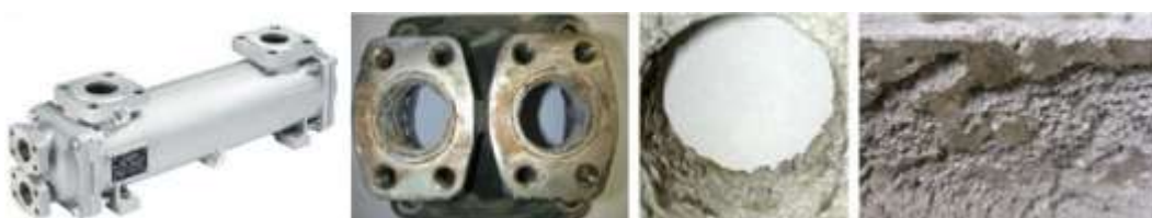
Kuva 8 Öljynlauhdutin, joka on rakennettu osista ja 3 eri materiaalista. (Groysman 2017 s. 191)
