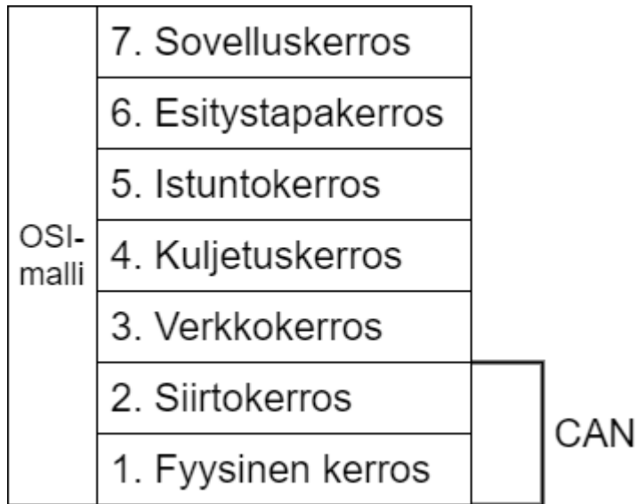
Kuva 9. CAN-protokolla määrittää OSI-mallin kaksi alinta kerrosta. Perustuu lähteeseen [63]
