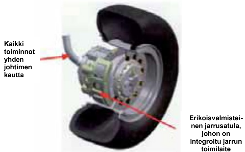
Kuva 6. SEP:n Magnetic systems technology -napamoottori, muokattu lähteestä [7].
