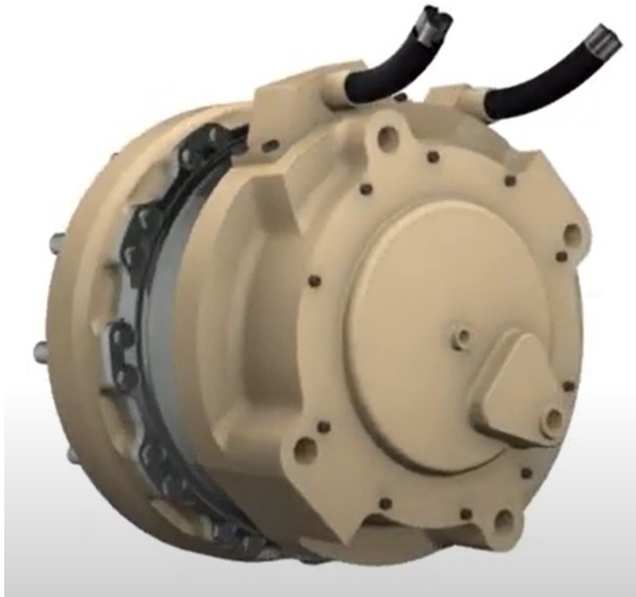
Kuva 13. QinetiQ:n “State of the art” -napamoottorimalli [16].
