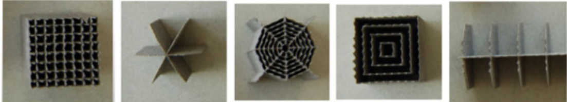
Kuva 4. Metallien 3D-tulostuksessa käytettävät yleisimmät tukigeometrit vasemmalta oikealle: lohko, tähti, verkko, reunus ja linja (Yang et al. 2017, s. 99)
