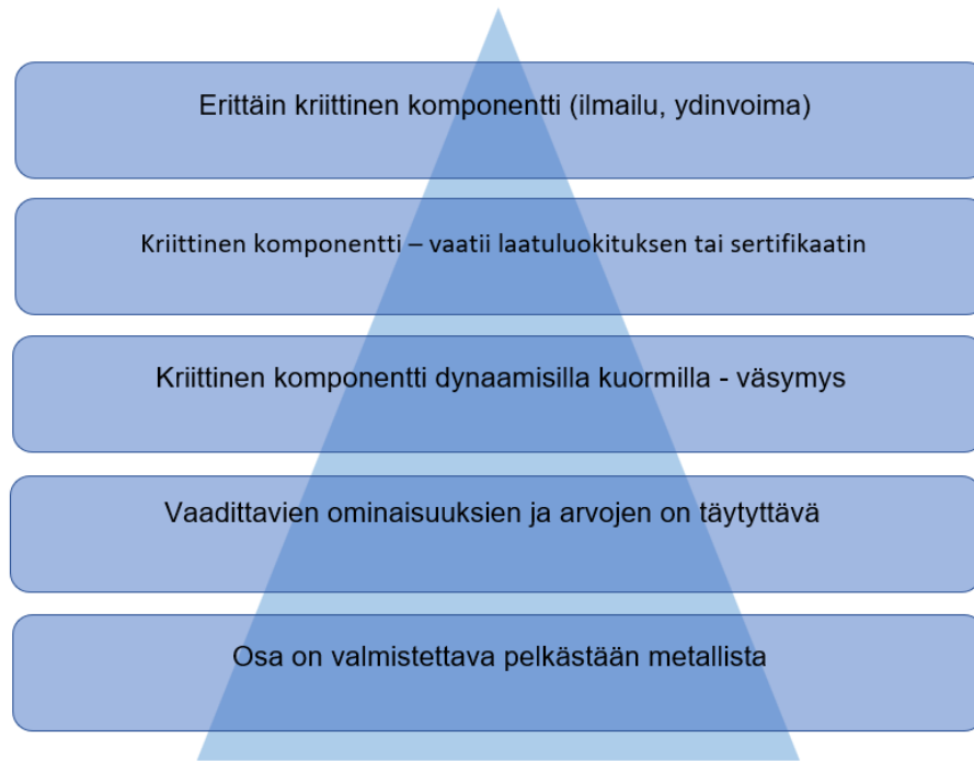
Kuva 6. Laatutasot metallin 3D-tulostuksessa alhaalta ylöspäin (1–5) luokiteltuna (Hämeenaho 2019)
