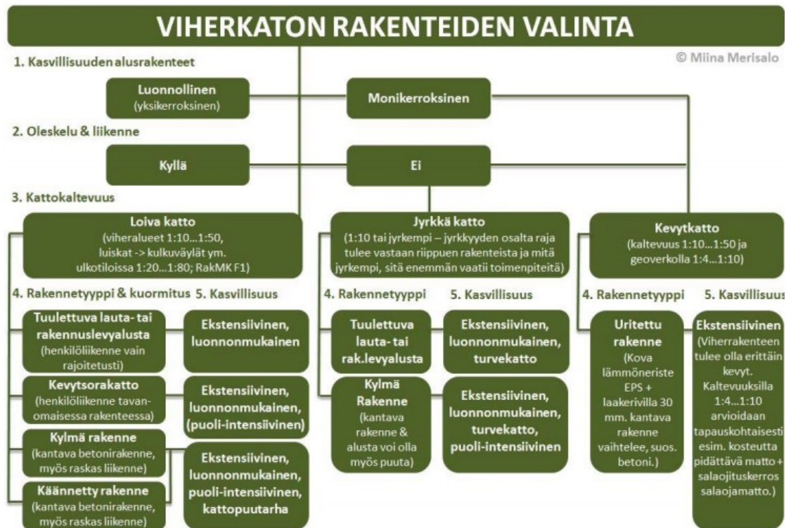
Kuva 7. Kaavio viherkaton rakenteiden valintaan Merisalo (2014)
