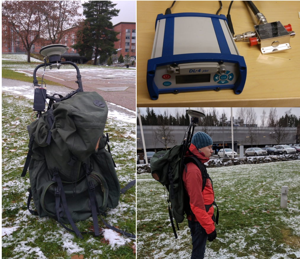
Kuva 1. Mittauslaitteisto. GPS–INS-laite mustan kotelon päällä. GPS-vastaanotin repun sisällä. Tukiasemavastaanotin kytkettynä kiinteään antenniin.
