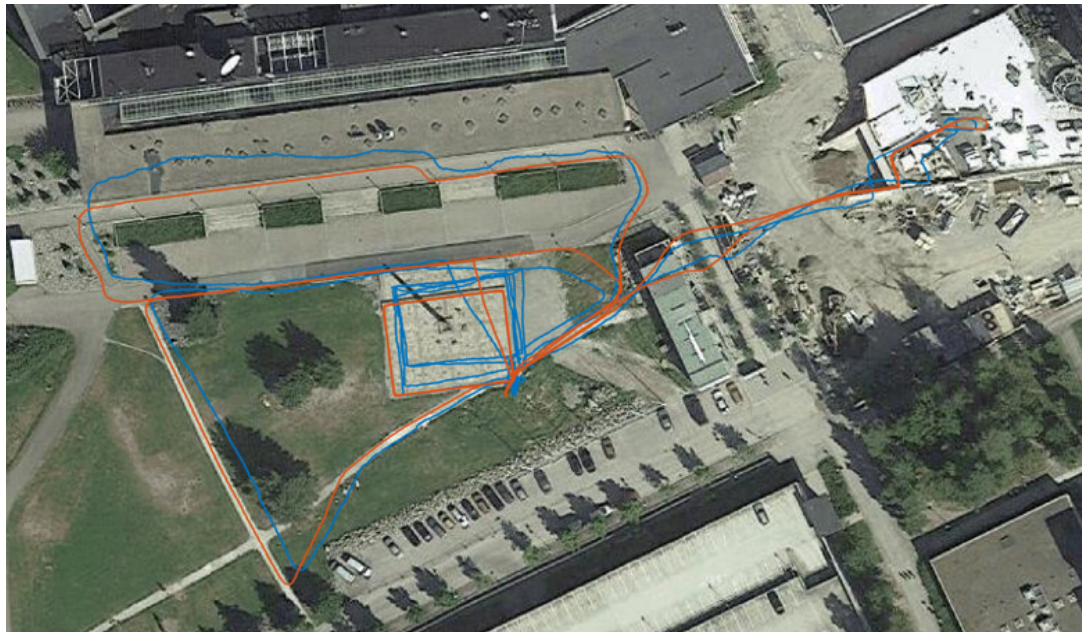
Kuva 2. Mittauksissa kuljettu reitti. Sinisellä GPS–INS-mittaus, punaisella referenssi. Karttakuvat © 2018 DigitalGlobe
