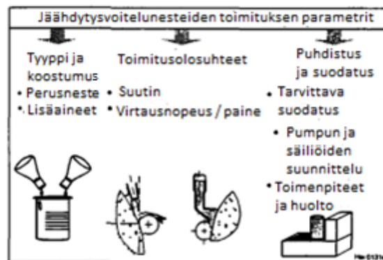
Kuva 7. Jäähdytysvoitelunesteiden käytön parametrit, jotka vaikuttavat prosessiin ja sen lopputulokseen (mukaillen Brinksmeier et al. 1999)
