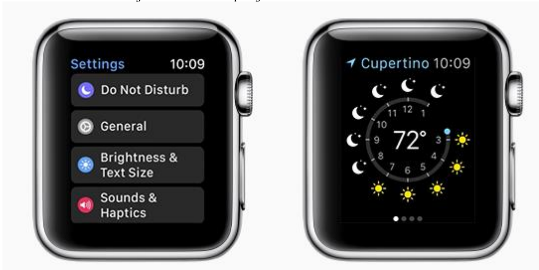
Kuva 4. Vasemmalla hierarkkinen malli, oikealla sivupohjainen malli. Oikealla puolella digitaalinen kruunu ja sen alapuolella käynnistysnappi. (Apple Developer, 2020)
