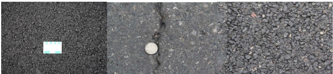
Kuva 12. Kumipäällyste valtateillä 7, 35 ja 115 (Hegazi 2014, s. 34, 41, 46)
