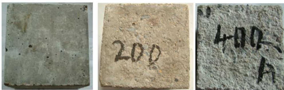
Kuva 1. Betoninäyte ennen jäätymis-sulamissyklejä, 200 syklin jälkeen sekä 400 syklin jälkeen (Shang 2014, s. 4)
