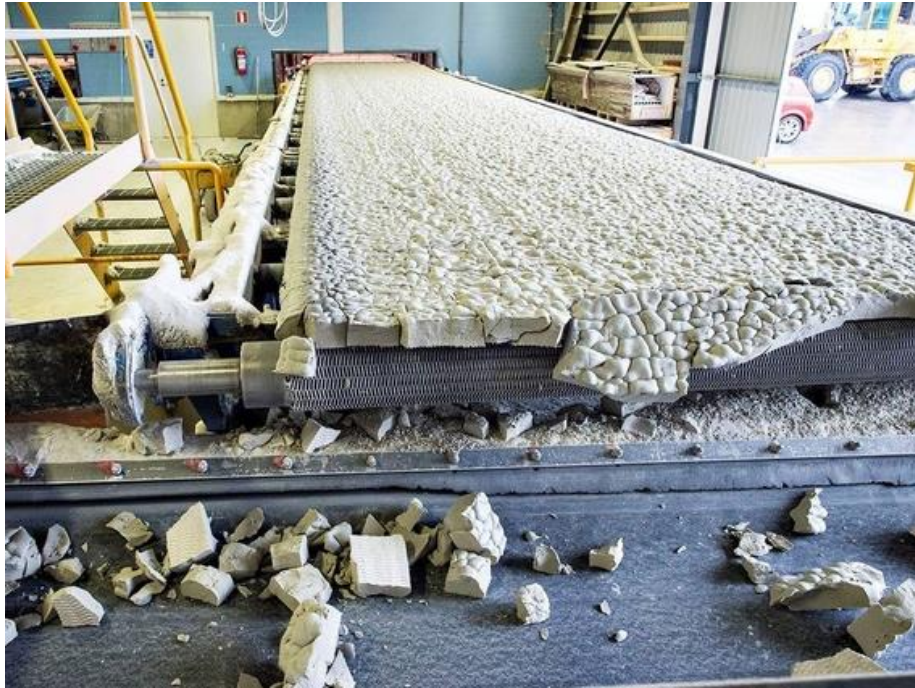
Kuva 3. Vahtolasilaatta murenee lämpöjännityksien vaikutuksesta. (Vanhanen 2015)
