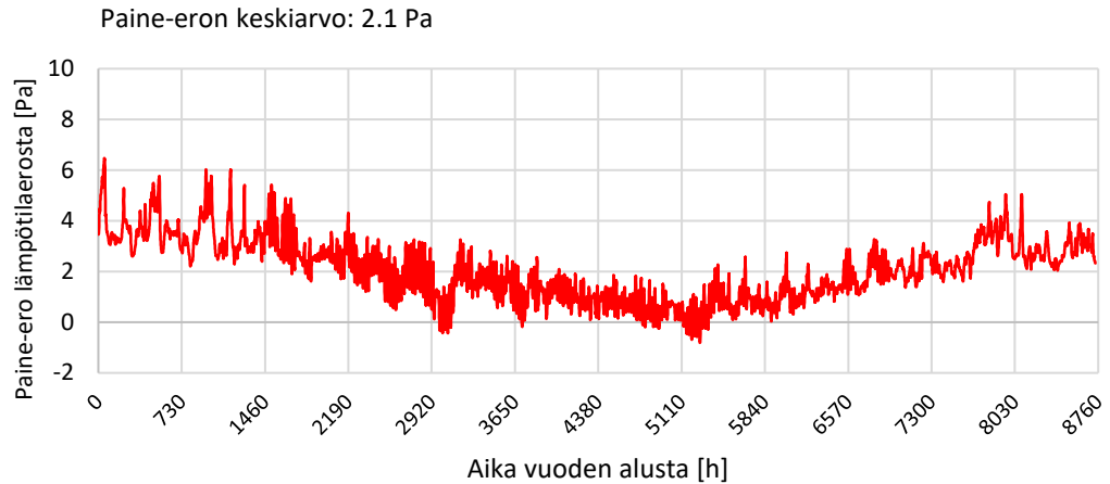
Kuva 3.16. Lämpötilaerosta aiheutuva paine-ero 6 m korkean, tasatiiviin rakennuksen yläosassa Jokioisilla vuonna 2004.
