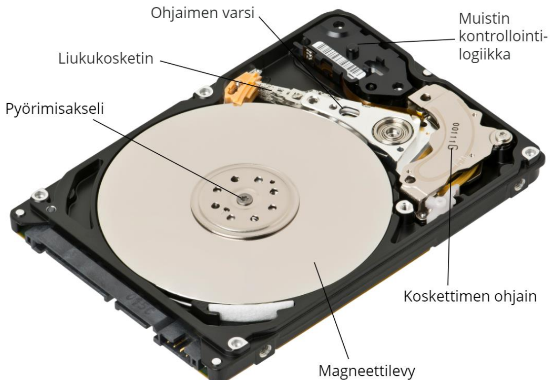
Kuva 3. Kiintolevyn sisäinen rakenne [35].
