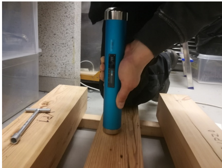
Kuva 4.3. Pilodyn-laite käytössä. Mittaustulos on luettavissa kuvassa näkyvästä mitta-asteikosta.
