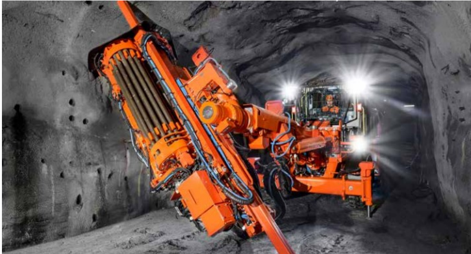
Kuva 3.7. Sandvik DL432 poraamassa yläkätistä viuhkaa.
