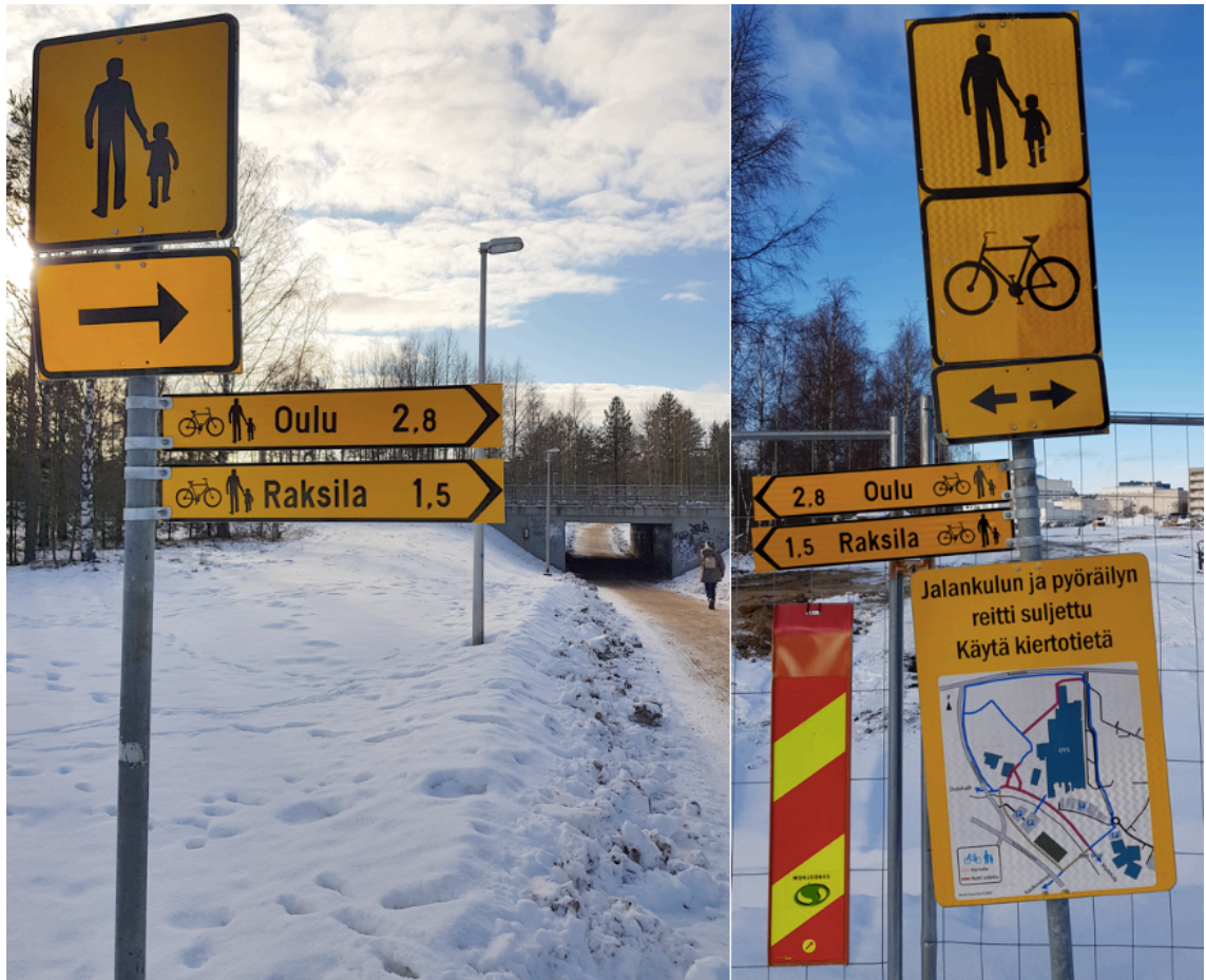
Kuva 20. Selkeästi toteutettu kiertoreitin opastus tilanteessa, jossa kevyen liikenteen väylä on jouduttu sulkemaan liikenteeltä.
