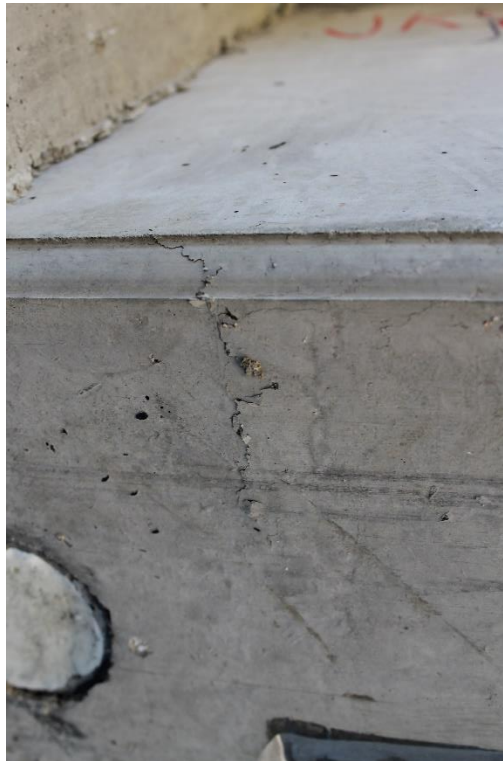
Kuva 71. Murtoon kuormitetun JK8-8-koekappaleen halkeama elementtipalkin alapinnassa ensimmäisen mittauspisteen läheisyydessä.
