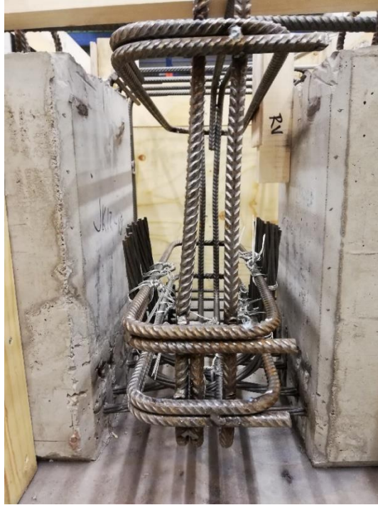
Kuva 34. Taivutettujen jännepunosten ankkuroiminen raudoitushäkkiin.
