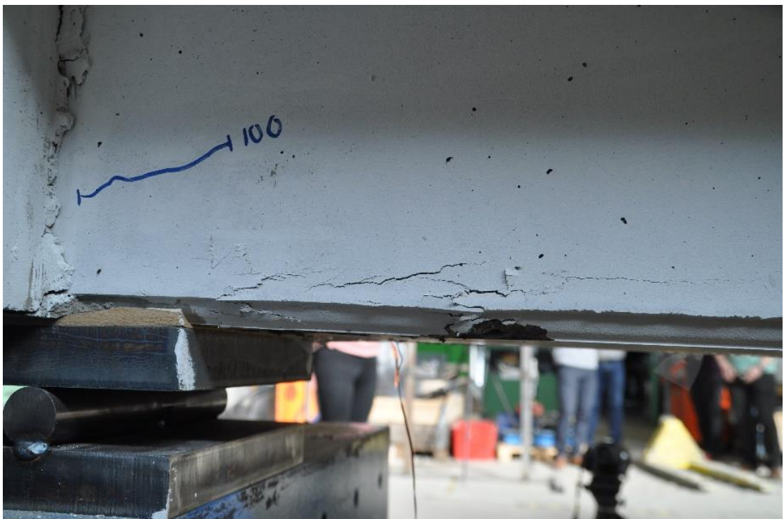
Kuva 73. Murtoon kuormitetun JK12-koekappaleen elementtipalkin alapinta.
