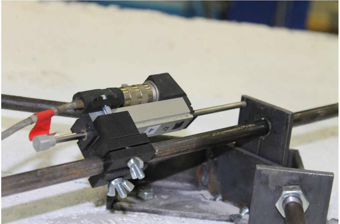
Kuva 61. Mittakellon kiinnitys terästankoon.
