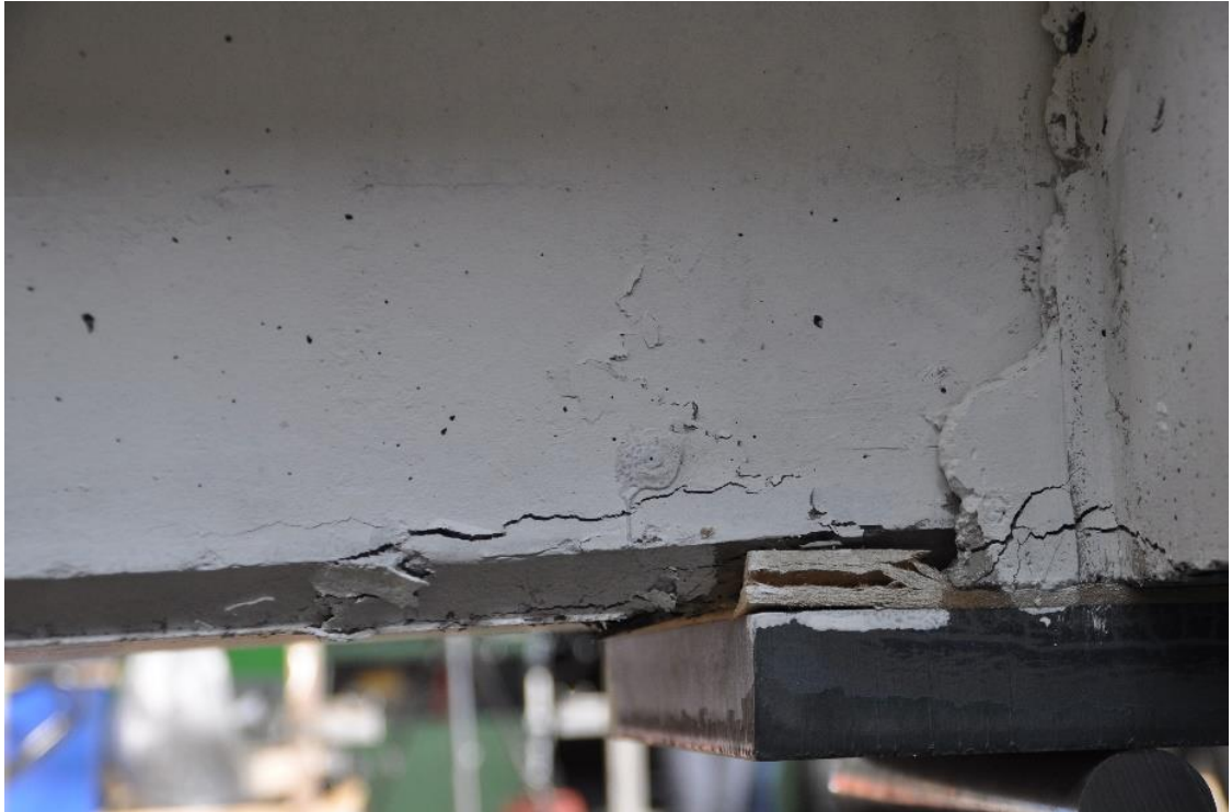
Kuva 74. Murtoon kuormitetun JK12-koekappaleen elementtipalkin alapinta.
