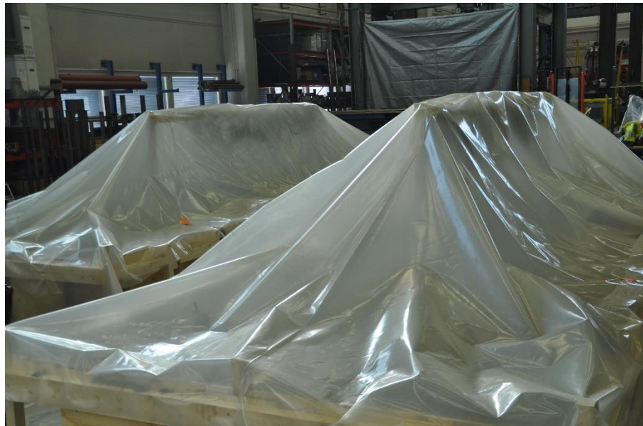
Kuva 40. Valumuottien suojaaminen muoveilla.
