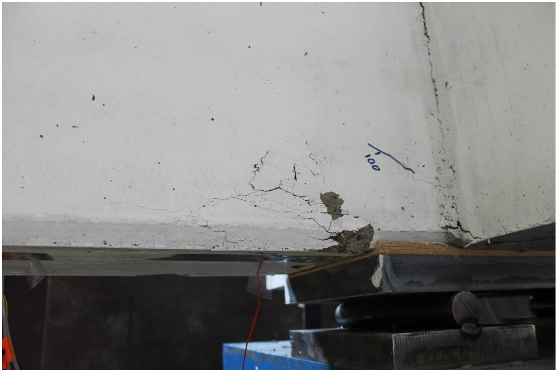
Kuva 72. Murtoon kuormitetun JK12-koekappaleen elementtipalkin alapinta.
