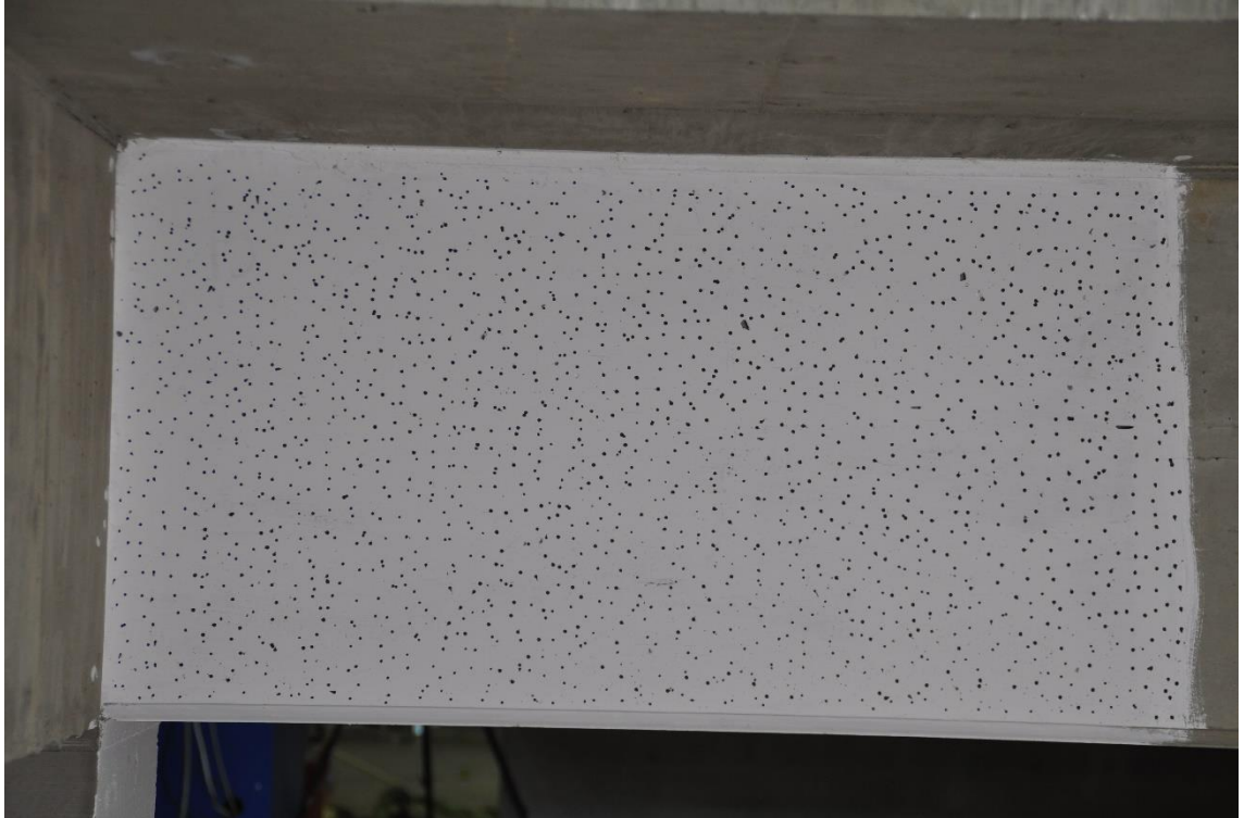
Kuva 64. Algoritmista laskentaa varten tehty pistekuvio palkin kyljessä.
