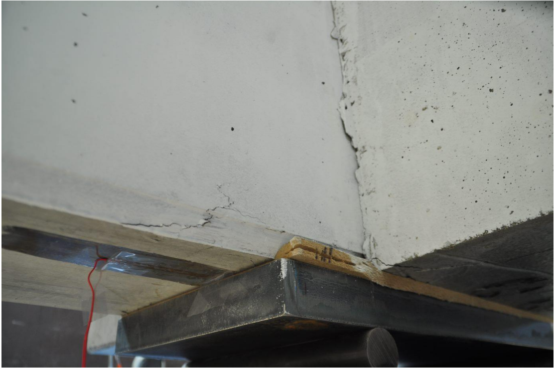
Kuva 70. Murtoon kuormitetun JK8-8-koekappaleen halkeama elementtipalkin alapinnassa ensimmäisen mittauspisteen läheisyydessä.
