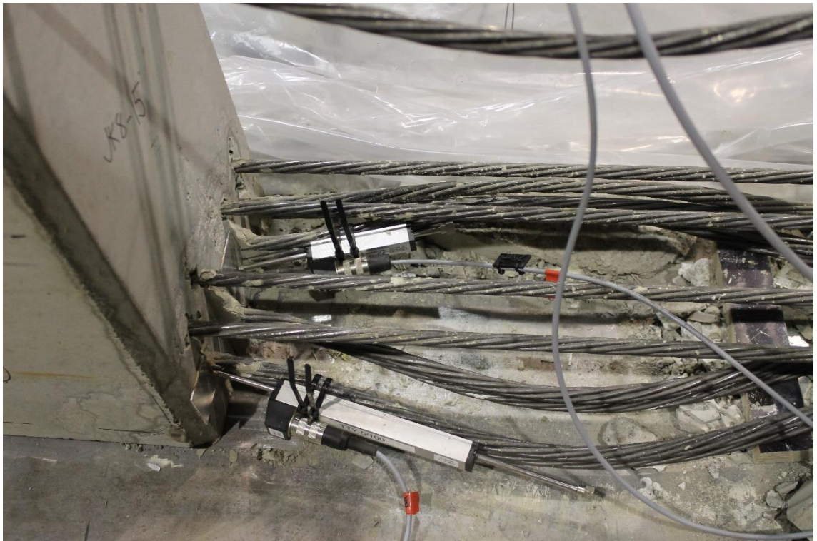
Kuva 24. Jännepunosten vääntyminen jännevoiman laukaisun yhteydessä.
