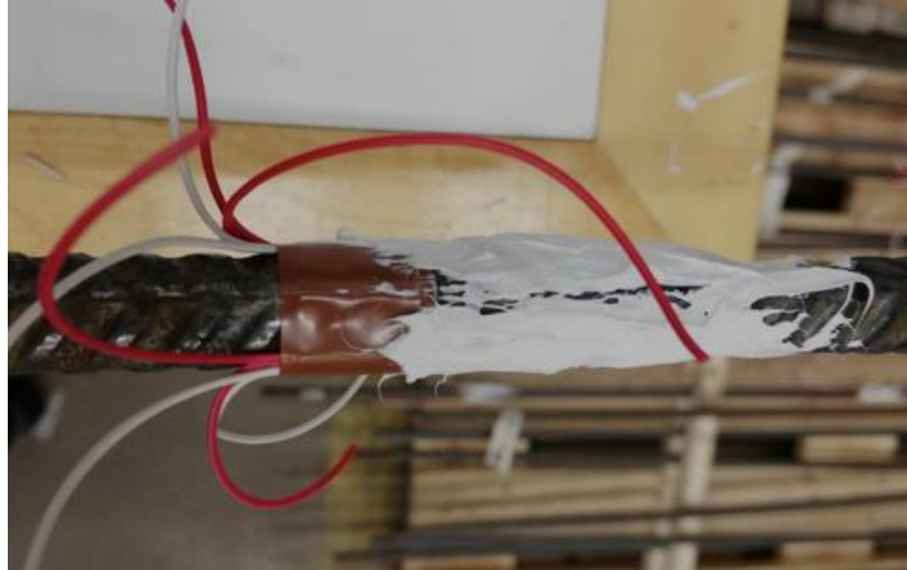
Kuva 15. Venymäliuskan suojaaminen elastisella massalla.
