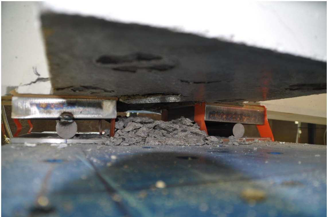
Kuva 66. Ensimmäisen koekappaleen murtuminen jatkosalueen alapinnasta.
