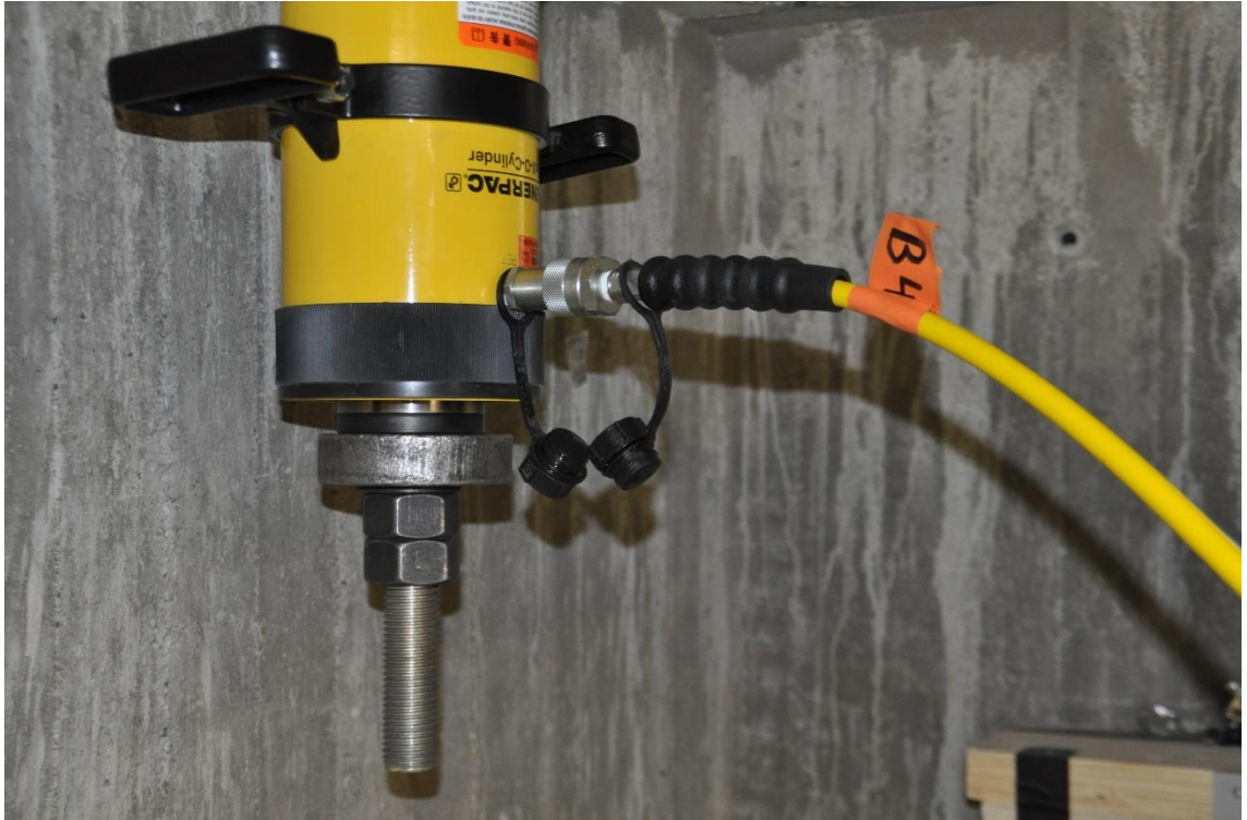
Kuva 52. Voimatunkin kiinnitys voimalattian alapuolelle vetotankoon.
