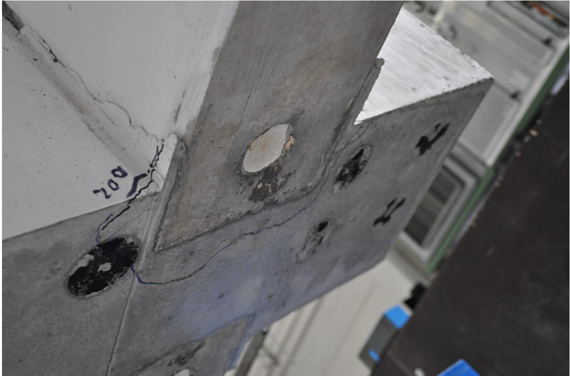
Kuva 69. Murtoon kuormitetun JK4-koekappaleen murtokohta.
