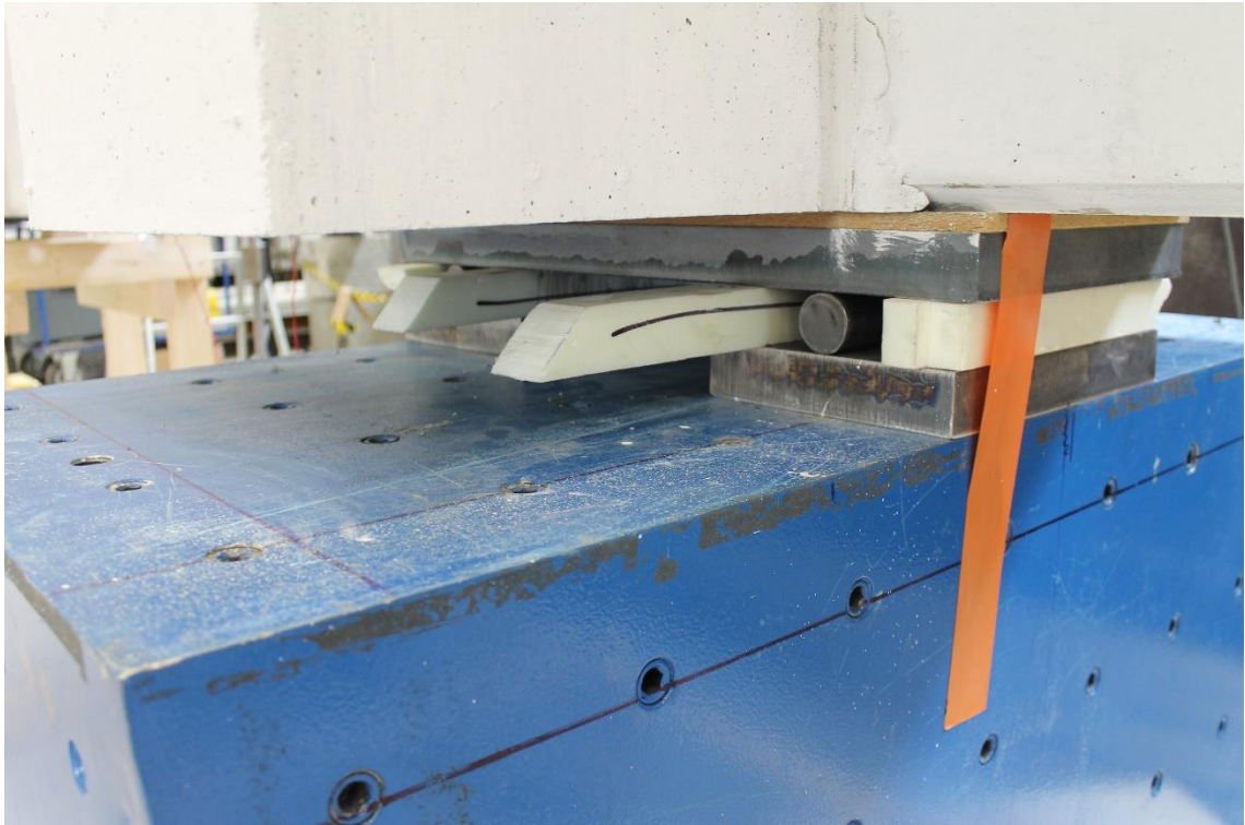
Kuva 68. Muokattu keskituen laakerituki.
