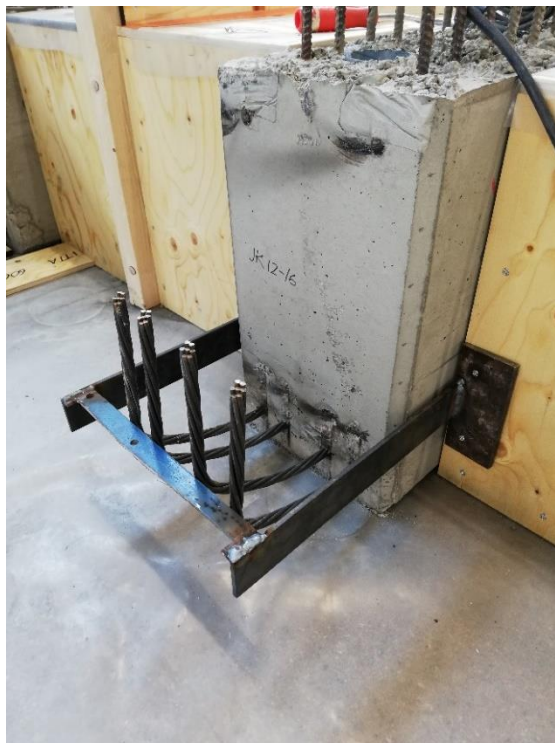
Kuva 32. Jännepunokset taivutuksessa pitävä tukirauta.
