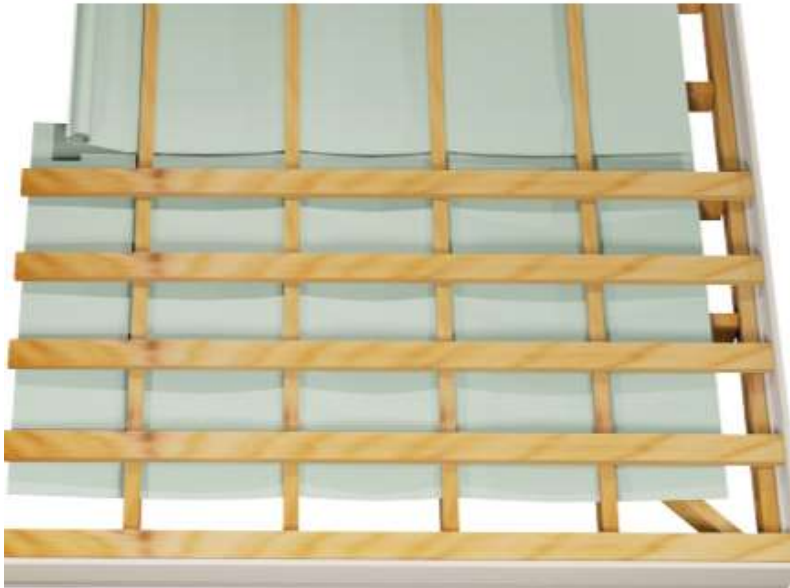
Kuva 6. Poimulevykatteen alusrakennetta: aluskate ja ruoderistikko (Poimukate.fi s. 14).
