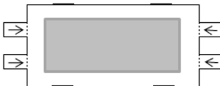
Kuva 14. Kuvassa harmaa alue on lasipari, johon lasiin kohdistuva jäähdytysilma tulee kammiouuniin lasin päädyissä sijaitsevista neljästä putkesta
