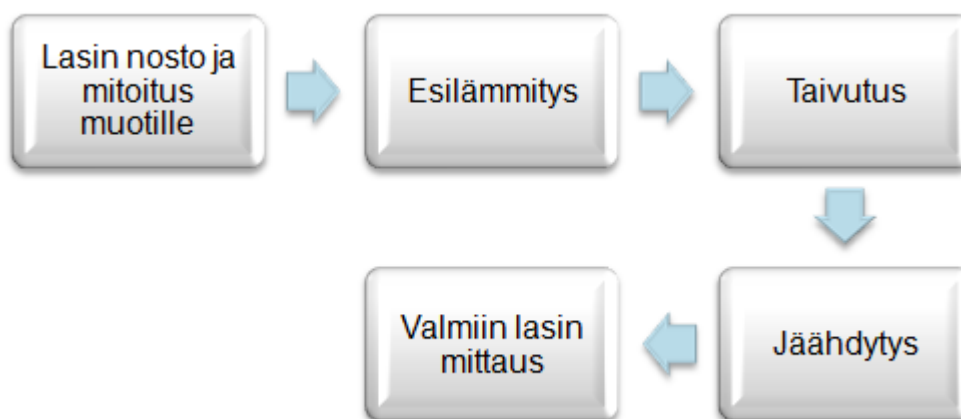
Kuva 13. Lasin taivutusprosessi tiivistettynä
