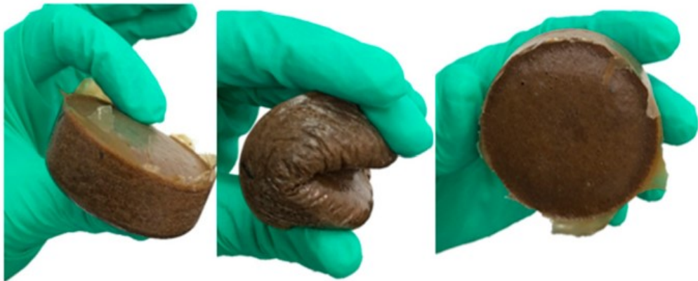
Kuva 15. Kuvassa esitellään ligniinillä lujitetun polyuretaanivaahdon palautumista mekaanisesta rasituksesta. [27, s. 501]
