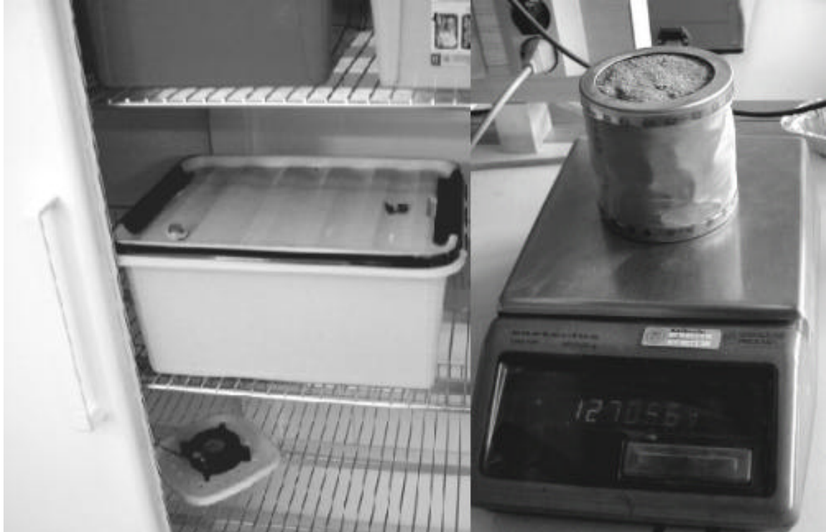
Kuva 6.7 Hygroskooppisen tasapainokosteuden määrittämisessä käytetty tiivis muovisäiliö, jonka ilmankosteutta on säädelty suolojen avulla sekä sullottu maanäyte.
