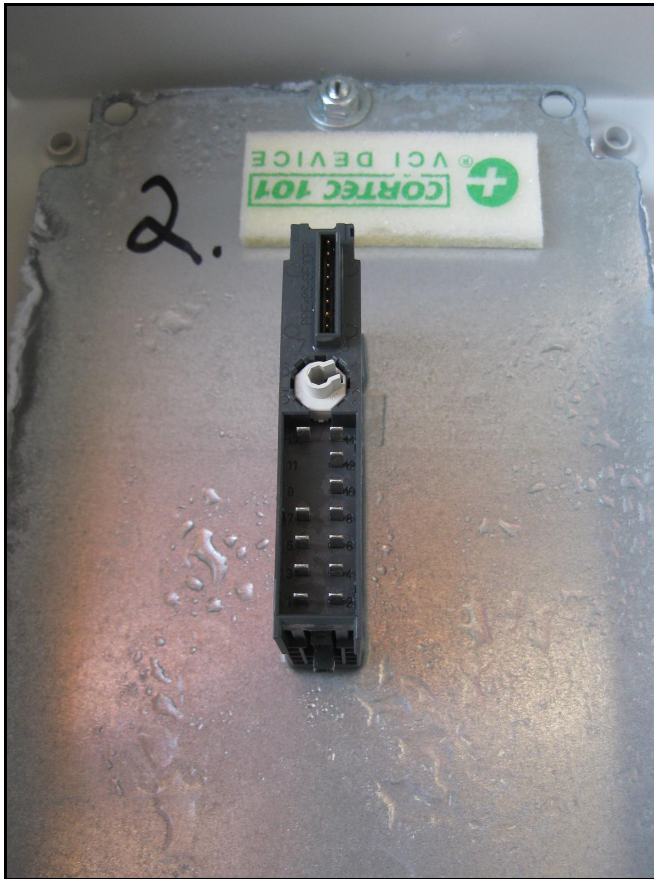
Kuva 6.6. I/O-kortti + Cortec 101 kytkentäkotelossa 2.
