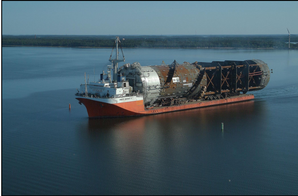
Kuva 3.14. SPAR-lautan rungon kuljetus Mäntyluodosta Meksikonlahdelle.
