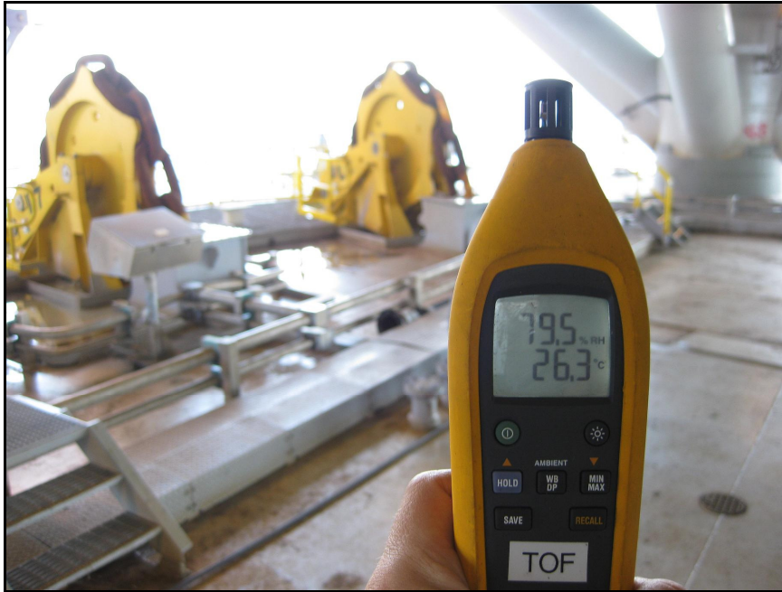
Kuva 4.2. Kosteus- ja lämpömittarin lukemat lautan kannella keskipäivällä.
