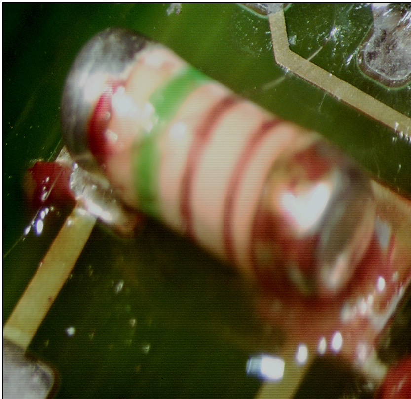
Kuva 6.19. Kytkentäkotelon 3 sisällä olleen piirilevyn korroosiovaurioita.
