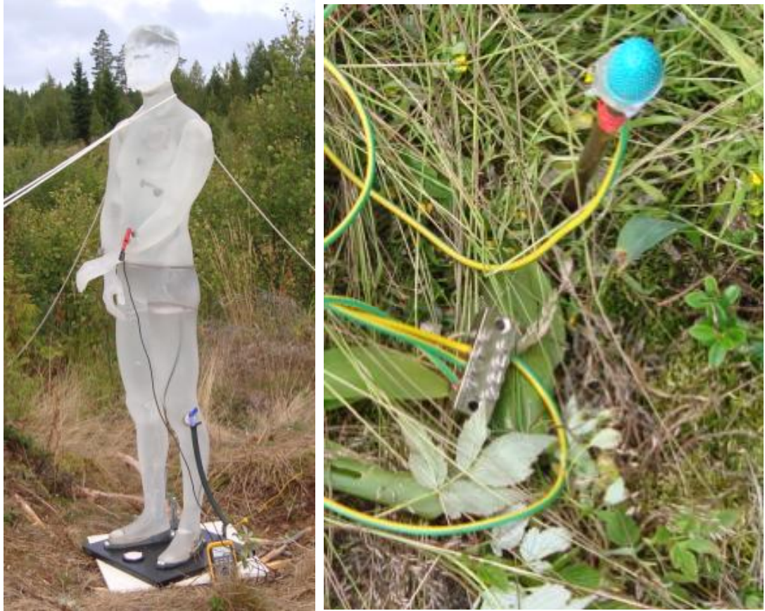
Kuva 6.8. Virran mittaaminen fyysisen mallin kädestä ja mittauksissa käytetty rautatangolla tehty maadoitus
