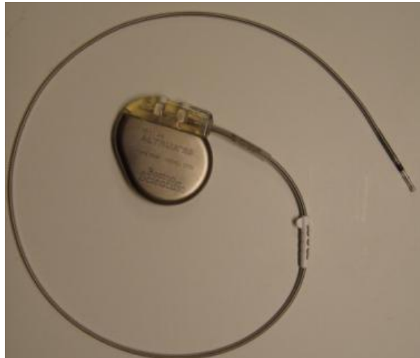
Kuva 3.2. Sydämentahdistin (Boston Scientific, Altrua 20 S201) ja tahdistinjohdo (Medtronic, Capsurefix Novus 5076 - 52cm)
