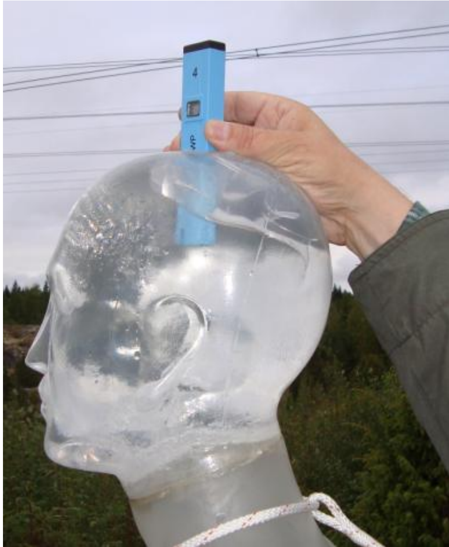
Kuva 6.12. Suolaliuoksen johtavuuden mittaus
