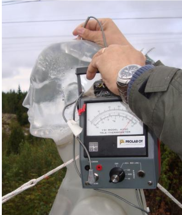
Kuva 6.9. Suolaliuoksen lämpötilan mittaus
