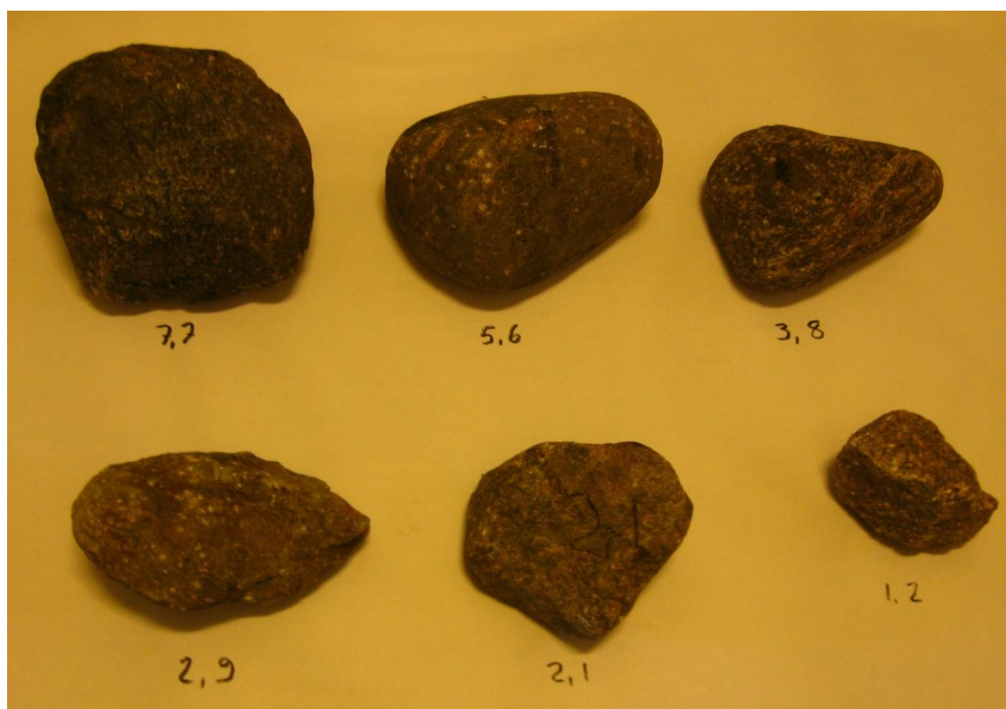
Kuva 5.1. Testikivet rullaston kivenkolahdusanalyysiin.
