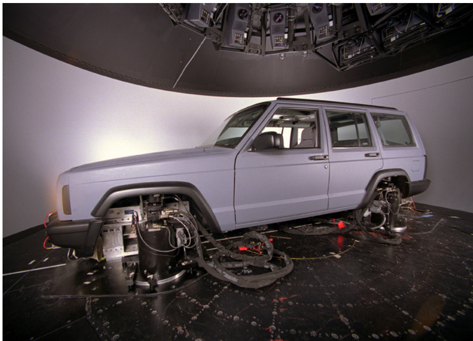
Kuva 3.7. NADS simulaattorin sisärakenne [20].
