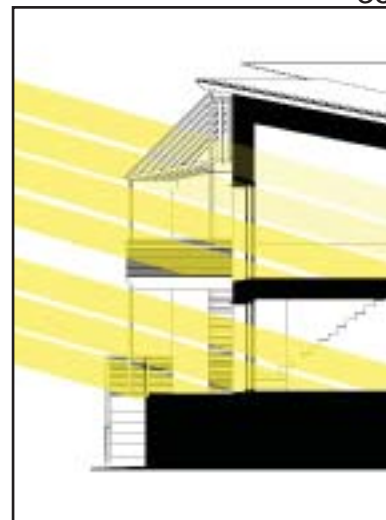
Talviaurinko pääsee huoneisiin
