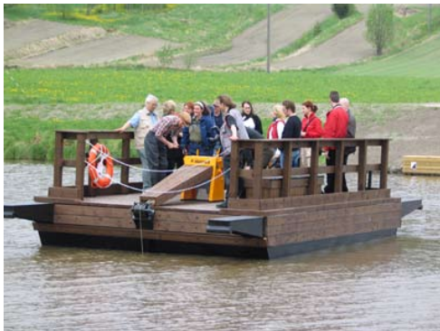
Kuva 39 alhaalla. Turun kampiföri, joka toimii myös ihmisvoimin vinssiä kampeamalla.
