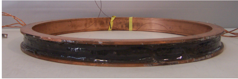
Kuva 4.9. MgB_2 :n potentiaalia MR-kuvaukseen demonstroiva solenoidikäämi, jonka valmistukseen on käytetty 820 metriä MgB_2 -johdinta. [27]
