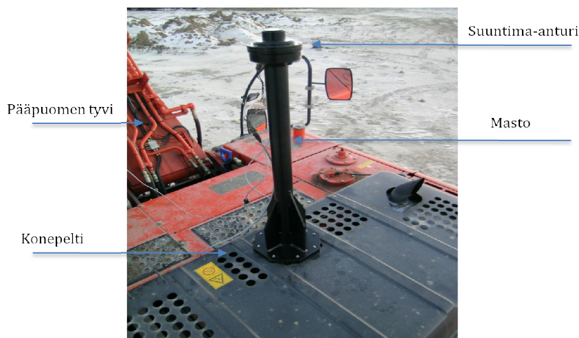
Kuva 4.1: Kaivinkoneen takakannelle asennettu suuntima-anturi
