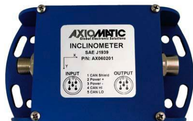
Kuva 2.9: Koneenohjaukseen soveltuva inklinometrianturi
