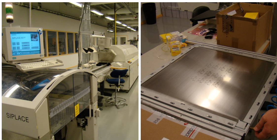
Kuva 3.8. Sensoriverkkoalustan valmistamisessa käytettyjä laitteita sekä stensiili.
