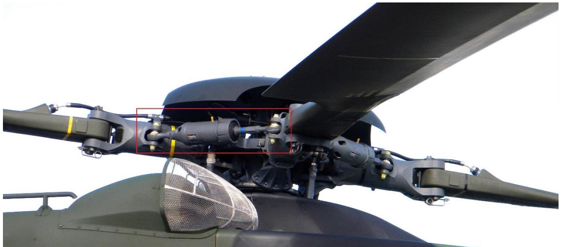
Kuva 6. Fluidlastic-vaimennin NH-90 helikopterissa (perustuu lähteeseen: Pöllö).
