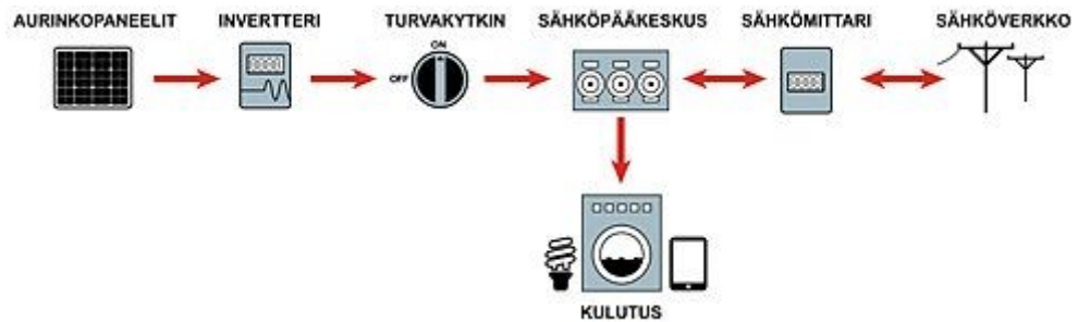
Kuva 6: Verkkoon liitetyn aurinkosähköjärjestelmän rakenne [6]
