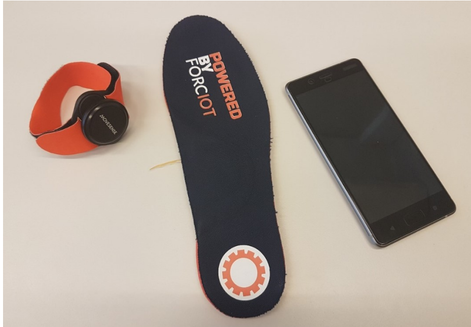
Kuva 3. Jauhiainen et al. tutkimuksessa [31] käytetyt mittauslaitteet. Vasemmalla Suunto Movesense, keskellä Forciot-älypohjallinen ja oikealla Nokia 8 -älypuhelin. Kuva: Milla Jauhiainen
