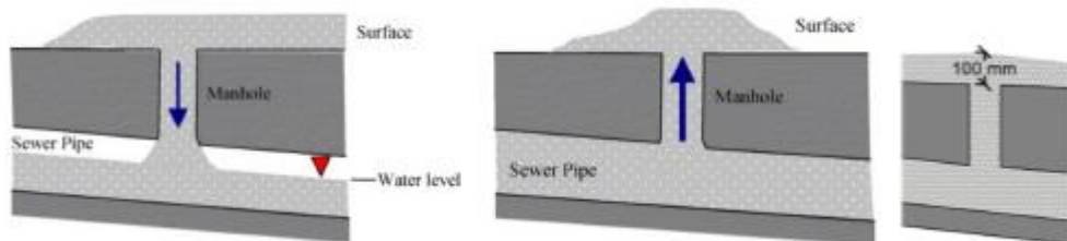
Kuva 11. Vasemmassa kuvassa on liian pienestä tulo- ja poistokanavasta johtuvaa tulvimista ja oikealla on hulevesiviemäriin kapasiteetin ylittymisestä johtuva tulva. Sallittu padotuskorkeus on +100 mm (Mark et al. 2004).
