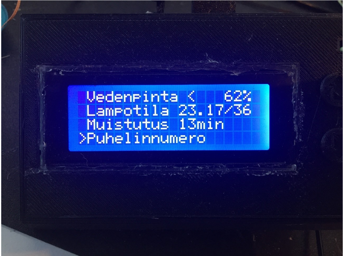
Kuva 23. Lämmitysavustimen käyttöliittymä, kun kaikki asetukset on otettu käyttöön.
