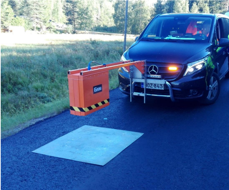
Kuva 11. Päällystetukan kalibrointi koekohteella Levannossa (Sekki 2018).
