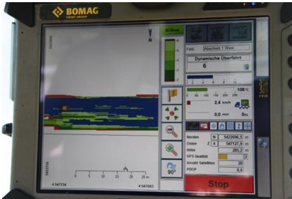
Kuva 15. Kuljettajalle tietokoneen näyttämä jyrän ylityskertojen lukumäärä (Kloubert & Scramm 2014).
