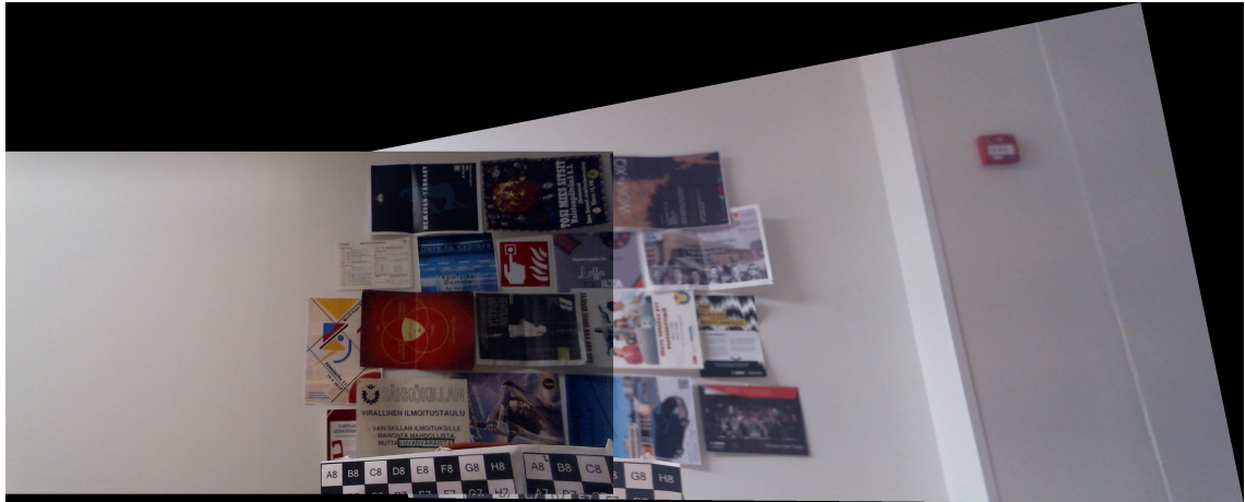
Kuva B.2 Mittaus kameroiden optisten keskipisteiden etäisyyden vaikutuksesta parallaksin suuruuteen. Optisten keskipisteiden etäisyys 96 cm, mittaobjektin etäisyys 75 cm.
