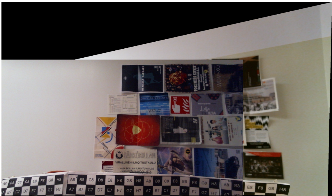
Kuva B.1 Mittaus kameroiden optisten keskipisteiden etäisyyden vaikutuksesta parallaxin suuruuteen. Optisten keskipisteiden etäisyys 8 cm, mittaobjektin etäisyys 75 cm.
