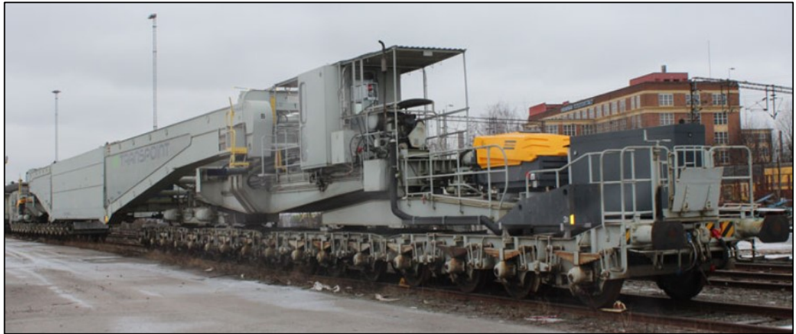
Kuva 2.4 Erikoiskuljetuksissa käytettävä suurkuormausvaunu Osg [17].
