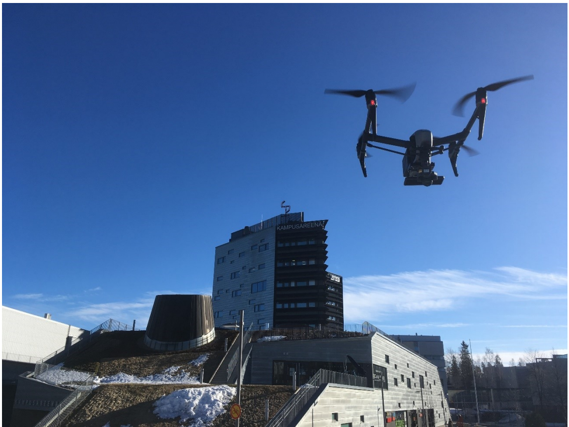
Kuva 8: Tässä työssä käytetty mittalaitteisto, sekä tukiasema-antenni taustalla Kampusareenan katolla.
